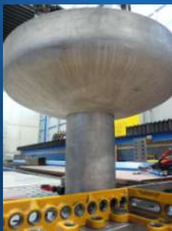
Klörperboden, 1.4301, Rohrausschnitt gelasert und Rohr lasergeschweißt
