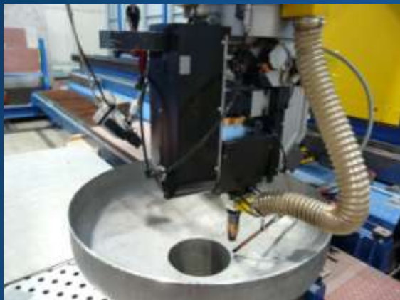
Klörperboden, 1.4301, Rohrausschnitt gelasert und Rohr lasergeschweißt
