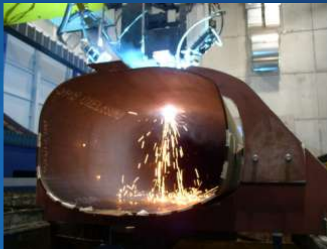
Kranausleger - Test Höchstfester Stahl, S1100
